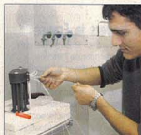
Michele Molinelli, ingénieur de projet, procède à l'empilement des «couches» de la pile.
