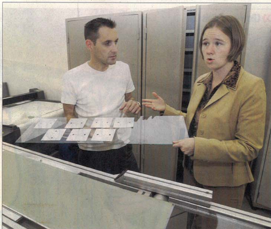
BANDE La fabrication des composants permettant de créer une pile à combustible se fait en utilisant des techniques «classiques» telles que la sérigraphie. Emily Thorn Corthay et Christophe Fournier présentent les «feuillets» qui seront encore transformés et empilés. YVERDON, LE 10 AVRIL 2007
